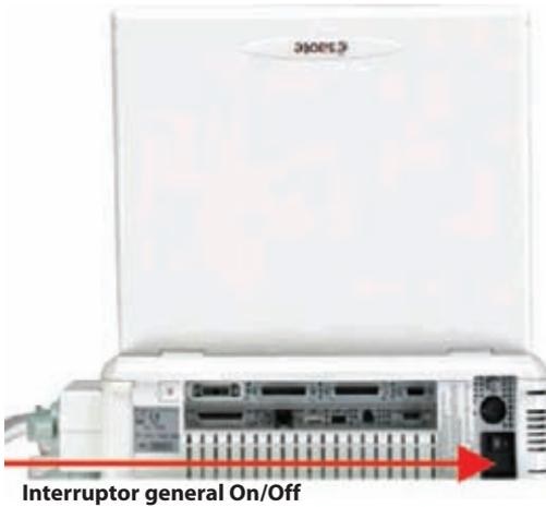
Figura 2.2 Botón de encendido y apagado.
